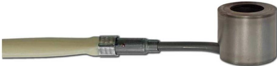
Le resistenze **SRTA** sono riscaldatori "HEAVY DUTY" progettati per impieghi ad elevate temperature e estesa durata operativa. Sono costituite da elementi spiralati Firecoil corredati di tubo riflettore in acciaio inox opportunamente dimensionato, il quale ha una funzione meccanica protettiva, ma soprattutto una funzione termodinamica migliorativa dell'efficienza nel riscaldamento dell'ugello.
