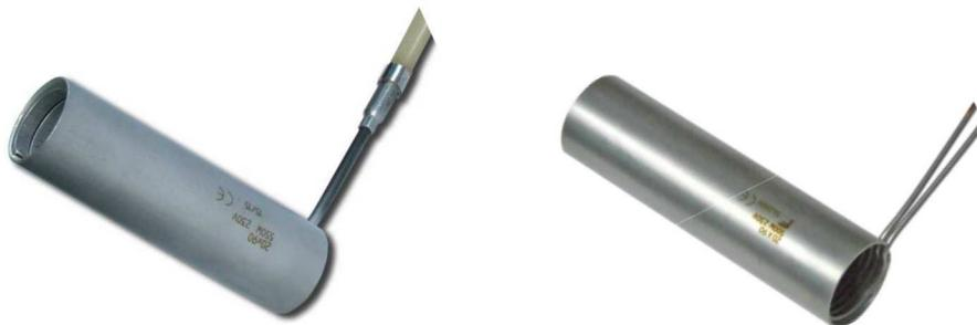
Le resistenze **SRT** sono riscaldatori Firecoil – Minifirecoil – Picofirecoil (scelte in base alle dimensioni richieste nell'applicazione) avvolti da un tubo riflettente in acciaio inox, che ha una funzione meccanica di proteggere la resistenza ed una termodinamica di aumentare il risparmio energetico diminuendo la dispersione del calore.
