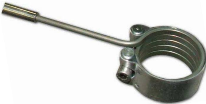
Le resistenze **CBFIR** sono riscaldatori Firecoil – Minifirecoil (scelte in base all'applicazione) corredate di una fascia di chiusura in acciaio per serrare la resistenza al corpo ugello in modo da ottenere un perfetto scambio termico. La fascia di chiusura svolge anche la funzione di riflessione dell'emissione IR prodotta dalla resistenza ed in tal modo recupera energia a beneficio di un rendimento termico decisamente più positivo.
